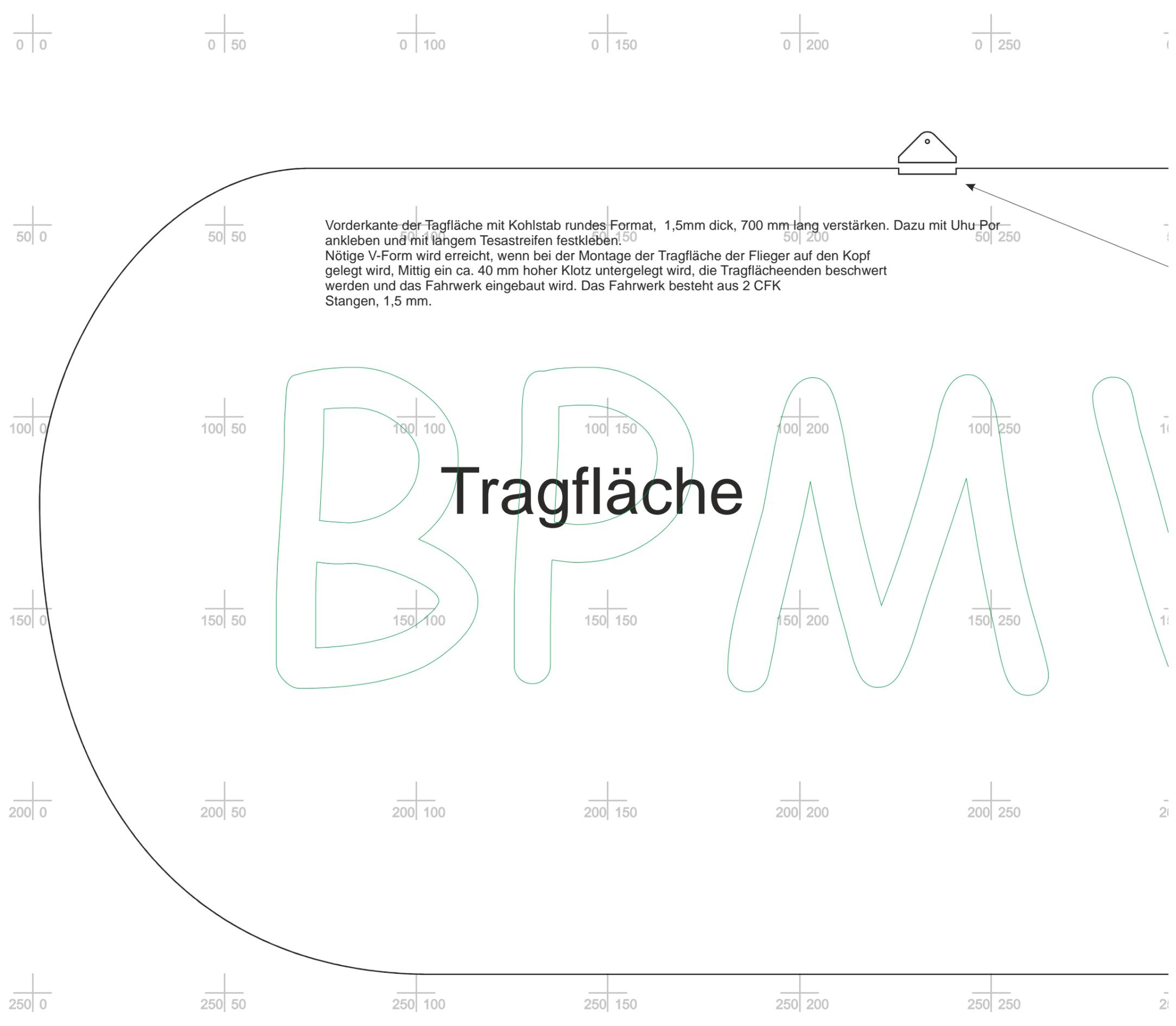
Vorderkante der Tragfläche mit Kohlstab rundes Format, 1,5mm dick, 700 mm lang verstärken. Dazu mit Uhu Por ankleben und mit langem Tesastreifen festkleben.
