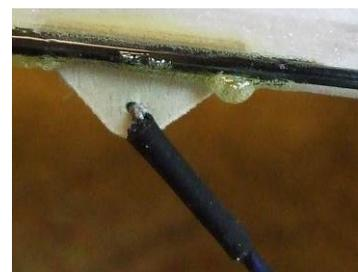
Nun wird die Tragfläche mit dem Gummi am Rumpf befestigt und „auf den Rücken“ aufs Baubrett gelegt. Der auf dem Rücken liegende Flieger wird in der Mitte mit 30-40 mm unterbaut (z.B. mit Styroporstücken). Um die V-Form der Tragfläche einzustellen werden beide Tragflächenenden mit Gewichten so belastet, dass diese bis auf das Baubrett heruntergedrückt werden.
