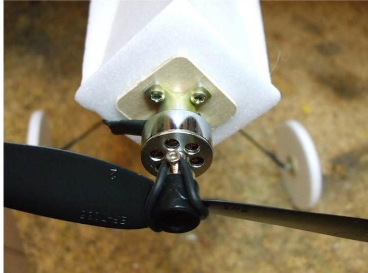
der Motor angebracht werden muss, sind vorgegeben und sollten nicht verändert werden. Nach dem Anpassen wird die Depron-Zwischenplatte und der Motorspant mit UHU POR auf der Rumpfspitze angeklebt.
