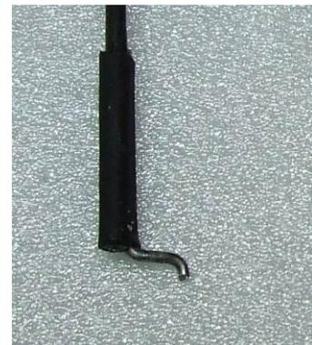
Nach dem Einschrumpfen können nun die Enden an der Tragfläche befestigt werden.
