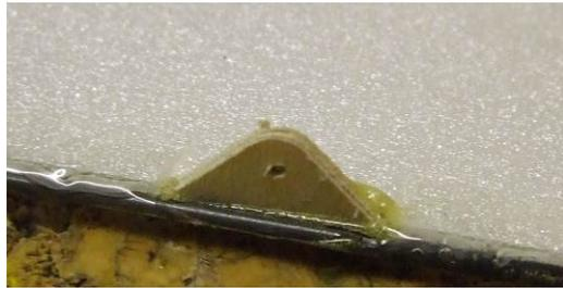
Am Rumpf wird der mittlere Verbindungspunkt der Fahrwerksbeine durch das Einkleben der Halterung erzeugt. Vor dem Anbringen müssen aber noch an dem senkrecht stehenden Seitenteil des Rumpfes die beiden Depron-Verstärkungen angebracht werden. Dies geschieht am besten durch flächiges Aufkleben mit Uhu Pur (nass in nass). Es hat sich als vorteilhaft erwiesen, beim
